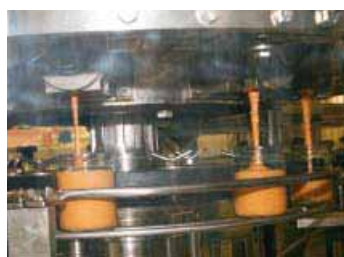
Abfüllung der Nussmuse an der modernen Kolbenabfüllanlage
