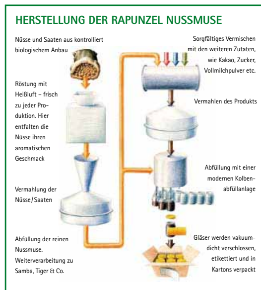
Abfüllung der Nussmuse an der modernen Kolbenabfüllanlage
